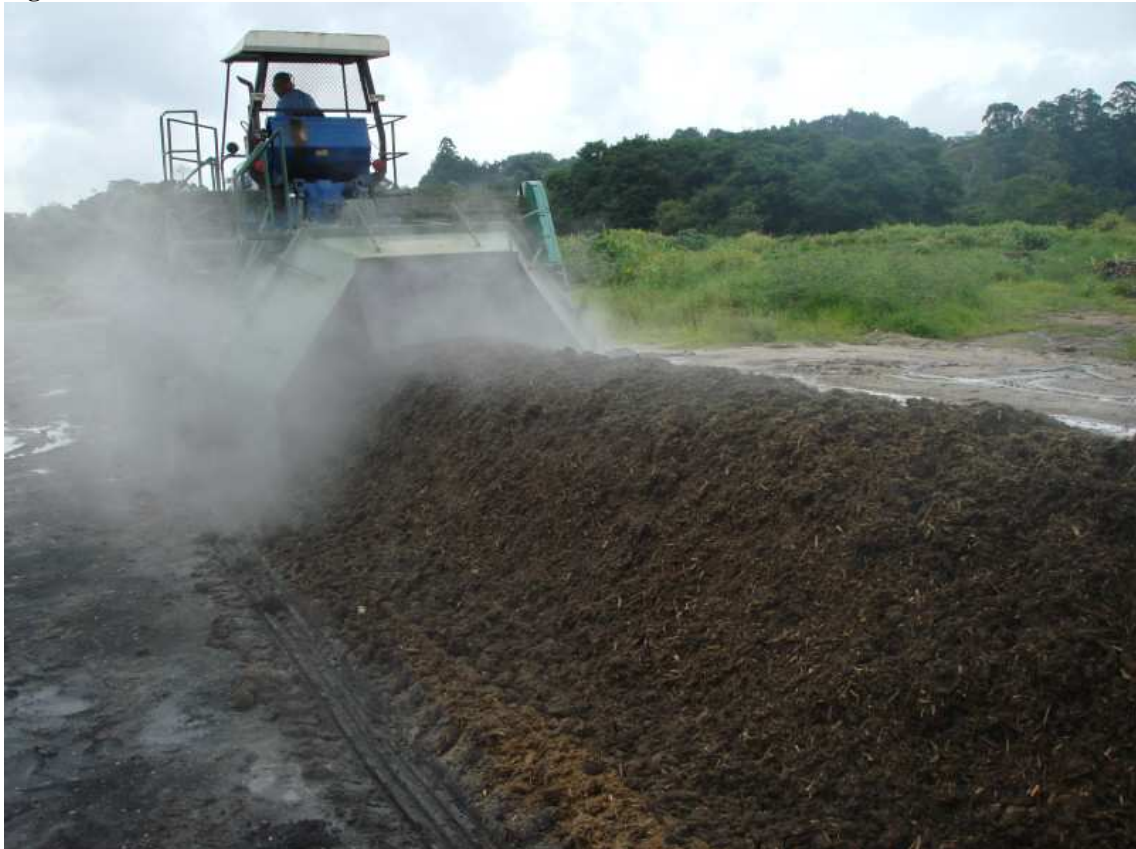
Figura 4.6: Revolvimento com o enleirador com liberação de vapor d'água
