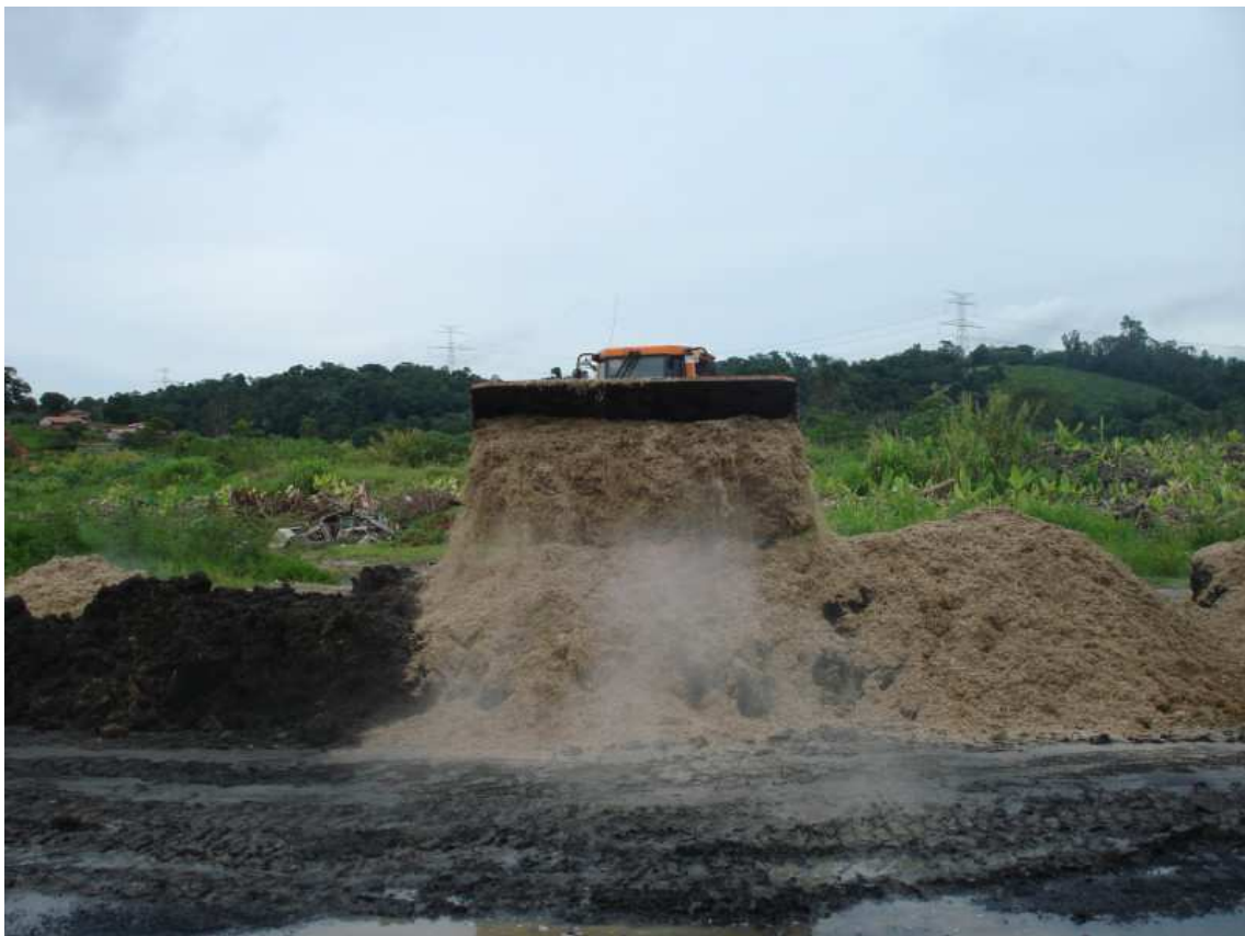
Figura 4.4: Mistura lodo com bagaço de cana
