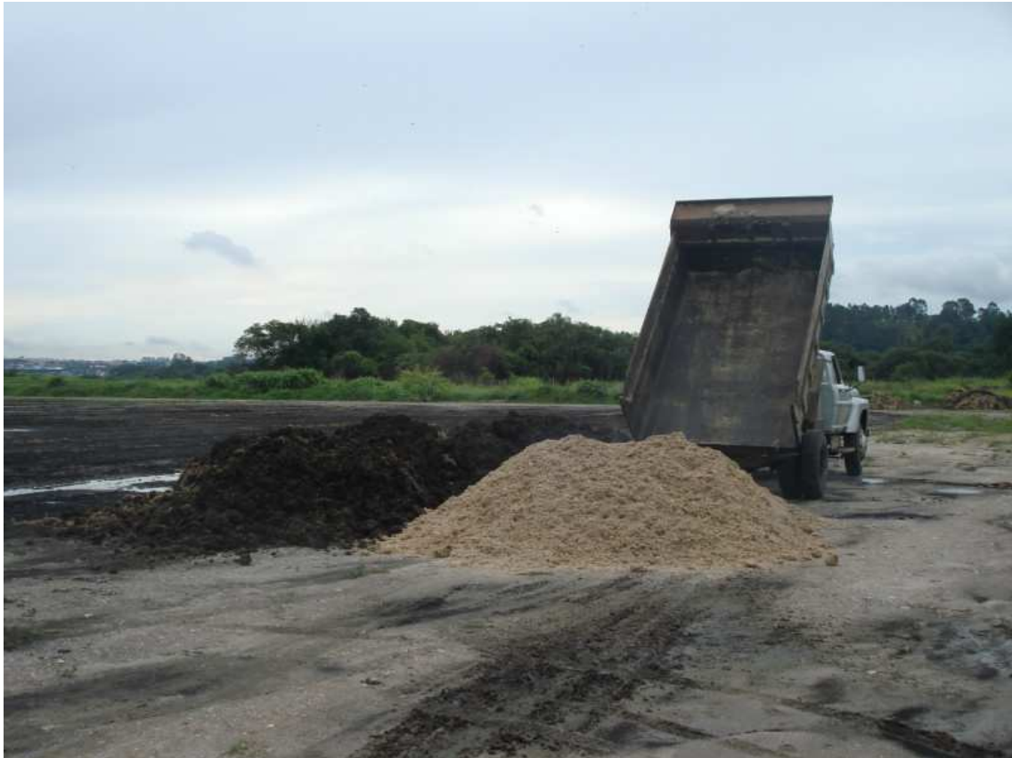
Figura 4.3: Preparação da mistura lodo com bagaço de cana
